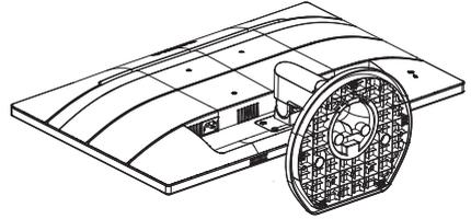
2. Appuyez sur les clips de verrouillage pour détacher le support de la colonne du socle.
