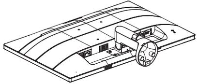
2. Tenez le support du socle du moniteur avec deux mains et insérez fermement le support du socle dans la colonne du socle.
