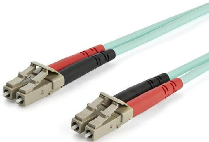
Ce câble patch à fibre optique duplex multimode LC-LC OM3 est doté d'une fibre optique de 50/125 microns et prend en charge la transmission de données à large bande passante sur une connexion 10 Gigabit Ethernet.
