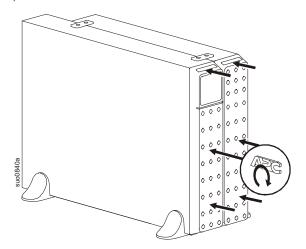
● 하단 배터리 모듈을 XLBP 에 밀어넣습니다 . ② 상단 배터리 모듈을 XLBP 에 밀어넣습니다 .
