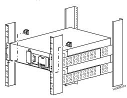
**4** Закрепите внешний батарейный блок в стойке. Затяните по два винта на каждом кронштейне.
