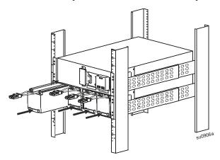
**7** Установите на место дверцы отсеков батарей. Затяните барашковые винты, чтобы закрепить дверцы.
